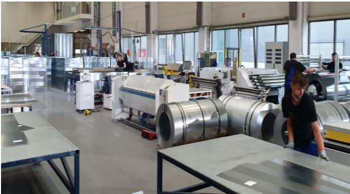
Fertigung von Lüftungskanälen
